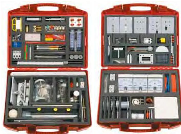
**В двух чемоданах:** рельс с ползунковыми опорами, штативами, стойками и подставкой для приборов; наборы муфт и разновесов, шкала с указателем и рулетка; стеклянная посуда, горелка; источники света, линзы, экраны, диафрагмы, зеркало и пр.; измерительные приборы, пружины, тележки, блоки и ведро Архимеда для опытов по механике и теплоте; измерительные приборы, оборудование и вспомогательные материалы для демонстрации опытов по электростатике, постоянному току и электромагнетизму.
