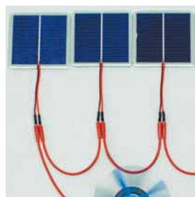
**В чемодане:** 6 солнечных элементов 0,5 В, 300 мА; электромотор с пропеллером; ванна для электролиза; угольные электроды; светодиод; хлорид натрия; соединительные провода; аксессуары.
