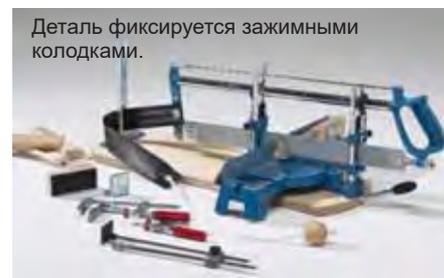
Деталь фиксируется зажимными колодками.
