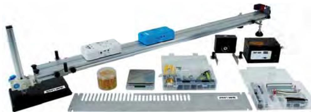
**Состав набора:** трек 1,2 м; 2 тележки с встроенными беспроводными датчиками, регулируемые по высоте кронштейны; пусковое устройство; электронные весы; виброгенератор; пластина алюминиевая с перфорацией; пружины, грузы, шкив, магниты, уровень, резиновые кольца.
