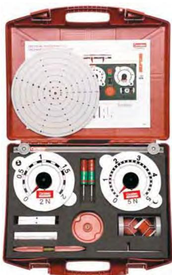
**В чемодане:** блок, таль, набор роликов, наклонная плоскость, рычаг с опорой и указателем, весы с чашками, набор щелевых гирь, рычаг, диск для измерения крутящего момента, динамометры с круговой шкалой (1 Н и 2 Н), цилиндрическая пружина, магниты, линейка с указателями, аксессуары.
