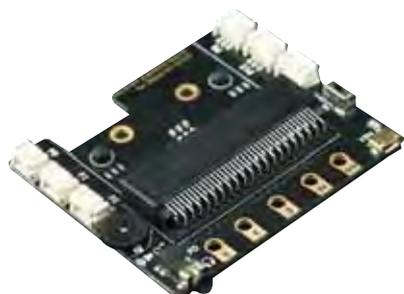
Использование платы micro:bit совместно с набором «Схематик» возможно благодаря плате расширения, которая имеет шесть трехпиновых разъемов для подключения модулей, регулятор громкости, разъем jack 3.5мм и Micro-USB. Такое решение позволяет разрабатывать проекты по таким направлениям как «Интернет вещей» или «Умный дом».
