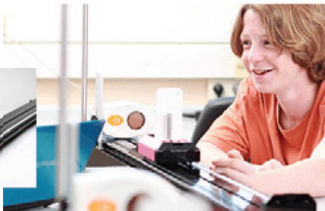
**Основные элементы установки:** дорожка и тележки с антифрикционным покрытием соприкасающихся поверхностей; приспособления для быстрой настройки экспериментов и подключения дополнительных датчиков.
