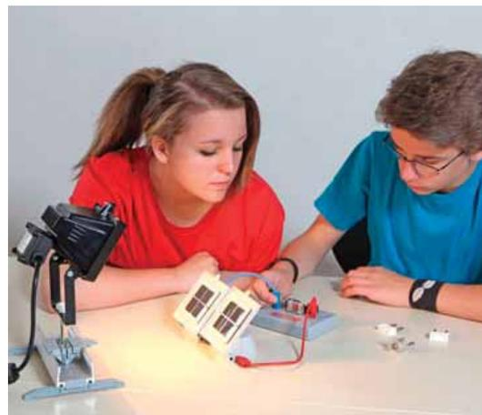
**В чемодане:** солнечный элемент и солнечные модули; кварцевая лампа; рельсовый профиль с опорами и ползунком с фиксатором; электромотор с пропеллером; плата для монтажа; пальчиковые аккумуляторы типа AA; соединительные провода со штекерами; источник питания; лампы; светодиод; мультиметр; аксессуары.
