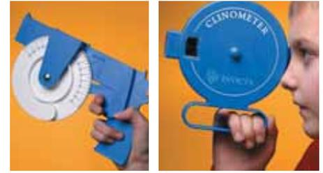
Клинометр позволяет измерять угол наклона линии или плоскости
