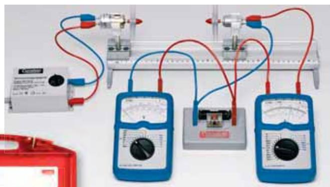
**В чемодане:** рельсовый профиль с подставкой и скользящими зажимами; роторы с лопастями; генератор и мотор; NiMH-аккумулятор типа AA, панель для монтажа сменных элементов, лампочки 1,5 В, светодиод, переменное сопротивление 50 Ом, диод; насос с мотором; аксессуары.
