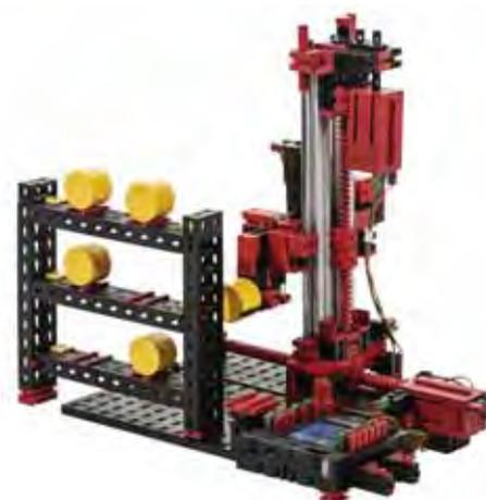
**В наборе:** контроллер ROBOTICS TXT, ПО ROBO Pro, USB-камера, 2 мотора с энкодерами, 2 мотора XS, мини-мотор, компрессор, светодиоды, 2 электромагнитных клапана, вакуумная присоска, оптический датчик света, 2 фототранзистора, термистор, 6 кнопочных переключателей, аккумулятор и зарядное устройство.
