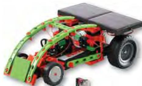
**В наборе:** контроллер LT, CD с ПО ROBO Pro Light, электронный модуль E-Тес, мотор XS, мини-мотор, «солнечный» мотор, компрессор, 2 «солнечных» модуля, онистор, светодиоды, фототранзистор, фоторезистор, кнопки, оптические линзы, а также дидактические материалы.
