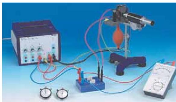
**Состав:** компактный аппарат Милликена, переключатель полярности, источник питания, кабели, мультиметр, штатив, микрометр, секундомер.
