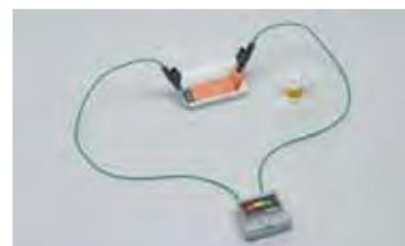
**В чемодане:** вольтметр; солнечный элемент 0,5 В/300 мА; фонарик, провода со штекерами, ванны для электролиза, медный и цинковый электроды; лимонная кислота, пробирки, магнитный стержень; аксессуары.
