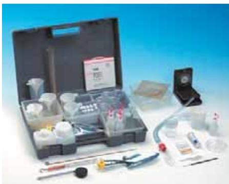
**В чемодане:** Тест-индикаторы кислотности и нитратов, чаши Петри, воронки, флаконы, капельницы, мерный цилиндр, мерная ложка, весы, рулетка, контейнер с лупой, сито, емкости для сбора образцов.
