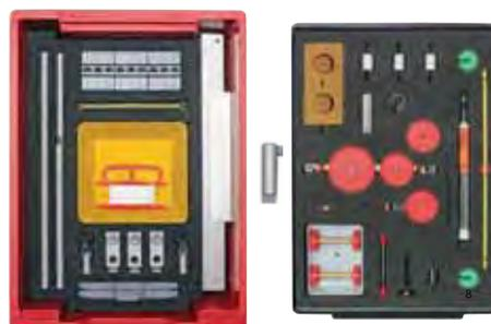
**В ящике:** пружины, ползунки, направляющий рельс, зажимы, ось, грузы, блоки, двойная муфта, опоры для рельса, брусок для измерения трения с отверстиями, динамометр, измерительная тележка, втулка зажимная, таль, стальной шарик.; аксессуары.
