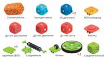
**Состав:** 10 функциональных модулей, включая моторы, сервопривод, датчики расстояния, движения, света и др.; соединительные элементы и адаптеры; колеса.
