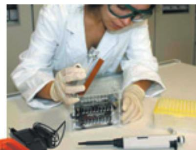
**Состав набора:** камера BlueGel для гель-электрофореза с встроенным трансиллюминатором; агароза в таблетках; дозатор (2-20 мкл); наконечники для дозатора; карта для пипетирования; лабораторные очки; шпатели; мерный цилиндр, 100 мл; колба Эрленмейера, 100 мл.
