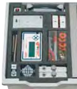
**В ящике:** рельсы с элементами крепежа (1000 и 360 мм); тележки (в т. ч. с мотором), фотоворота; грузики; цифровой таймер CoGEx Qt с кабелями, источником питания, инструкцией и программным обеспечением (англ. яз.); набор пружин; аксессуары.
