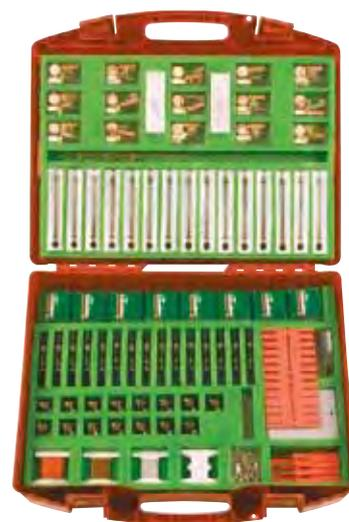
**В чемодане:** образцы различных материалов для изучения проводимости металлов; набор лампочек с патронами, батареи 4,5 В; рубильник и другие элементы электрической цепи; катушки с медным проводом в изоляции; термометр со шкалой от  $-3$  до  $+103$  °С; аксессуары.
