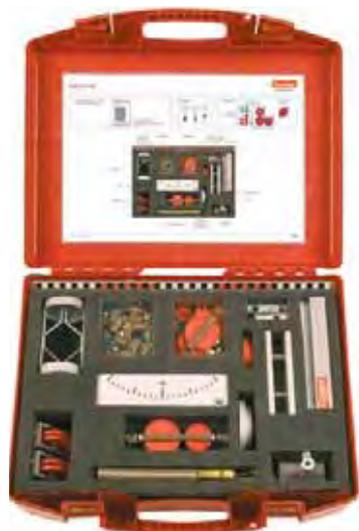
**В чемодане:** рельсовый профиль со штативом, весы, рычаг с опорой и указателем, динамометр, блок, оси на стержне; кольца с крючками, цилиндрическая пружина, гири с двойным крючком; аксессуары.
