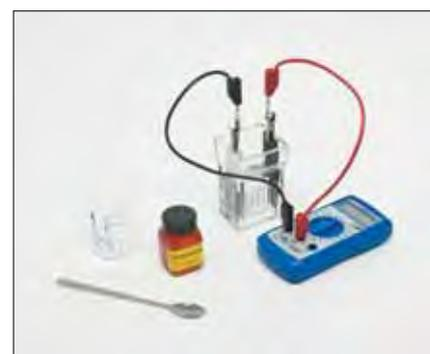
**В лотке:** стеклянный сосуд; электроды (угольные, свинцовый, цинковый, медный, железный); мультиметр, индикаторный светодиод; гидрат лимонной кислоты, хлорид натрия и сульфат меди; аксессуары.
