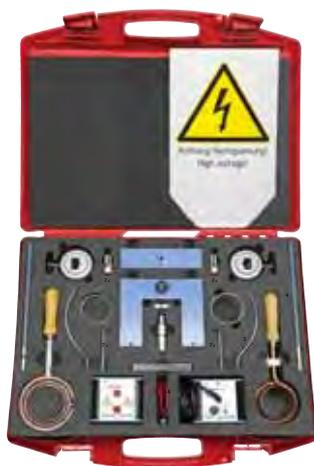
**В чемодане:** катушка первичная (600 витков) со шнуром питания (220 В) и двухполюсным выключателем, катушка вторичная (24000 витков), катушка вторичная медная (5 витков) с деревянными ручками, плавильный желоб, сердечник с ярмом и зажимами, электроды, набор колец, свеча зажигания, стойки, изолирующий стержень, провода со штекерами.
