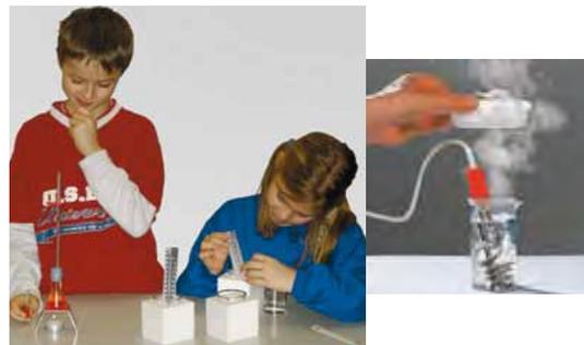
**В чемодане:** термометры: неградуированный, со шкалой (от  $-3$  до  $+103$  °С) и демонстрационный; калориметры; набор посуды из стекла и пластика с подставками; кипятильник (300 Вт, 220 В), свеча в металлическом держателе; аксессуары.
