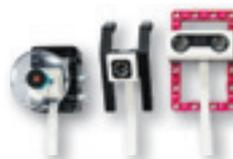
датчик расстояния ультразвуковой; датчик силы, (функционирует как датчик касания, распознавая нажатие, отпускание датчика и кратковременный клик), датчик цвета.
