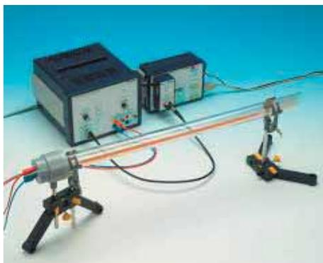
Порошок захватывается движением воздуха, созданным акустической волной в трубе, и формирует горки в местах узлов, которые остаются и после выключения звука. Исходя из длины трубки и количества узлов, можно рассчитать скорость звука в воздухе и длину волны стоячих волн.
