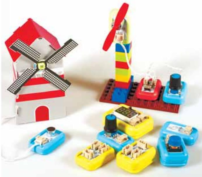
Набор включает более 40 различных модулей, для работы с которыми не требуется пайки или программирования.
