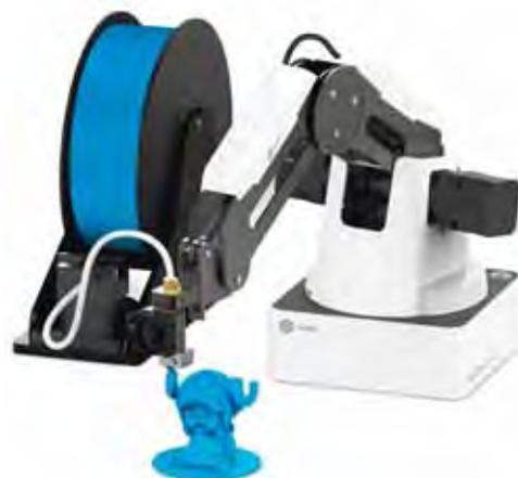
Многофункциональная система в виде роботизированной руки способна печатать 3D фигуры, выполнять лазерную гравировку, воспроизводить на бумаге различные чертежи, схемы и рисунки, манипулировать предметами.
