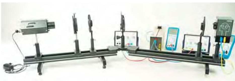
**Состав:** фотоэлемент для определения постоянной Планка (в корпусе), диапазон длин волн 185 – 650 нм; оптическая скамья; дифракционная решетка 600 линий/мм; цветной светофильтр, 595 нм, красный; линза в оправе,  $f=+100$  мм; диафрагма регулируемая; светодиод; реостат; соединительные провода; универсальный усилитель; источник питания; мультиметр цифровой.
