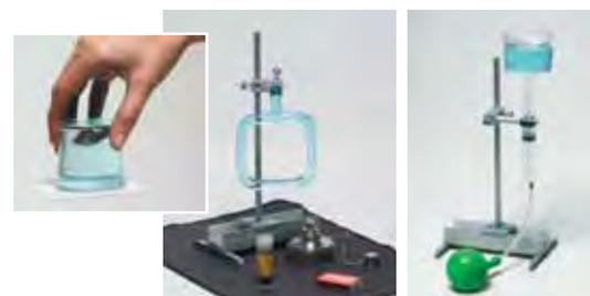
**В коробке:** профильный рельс с элементами штатива, колба Эрленмейера 100мл, лабораторная посуда, термометр с диапазоном измерения  $-10^{\circ}\text{C}$ ... $+110^{\circ}\text{C}$ , спиртовка, надувные шары; модель воздушного шара; шприц градуированный 30 мл; трубка конвекционная стеклянная; калориметр; диск для воздушной подушки; пластина биметаллическая; шланг резиновый 3м; резиновые пробки.
